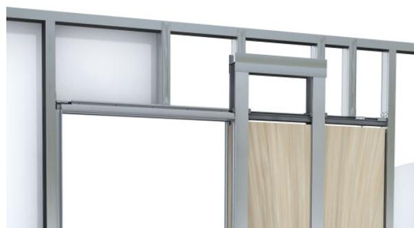
Kod pričvršćivanja drvenog krila sa upuštenim držačem vratnog krila potrebno je posebno poručiti prikriveni držač i masku. Kod ugradnje upuštenog držača vrata za težine vrata  $> 80 \text{ kg} \leq 120 \text{ kg}$ , treba koristiti vratno krilo od punog drveta ili sa ramom vratnog krila širine od  $\geq 70 \text{ mm}$ .
